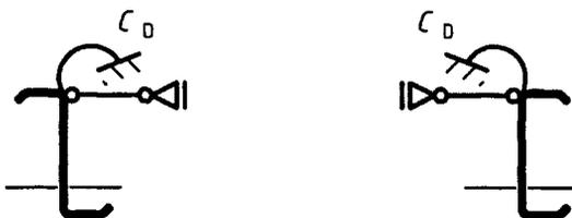
Panne modélisée comme contreventée latéralement avec maintien élastique en rotation  $C_D$  assuré par les plaques.
