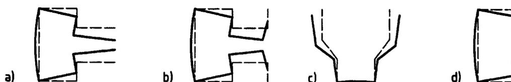
Figure 6.4 : Exemples de modes d'instabilité de forme transversale
